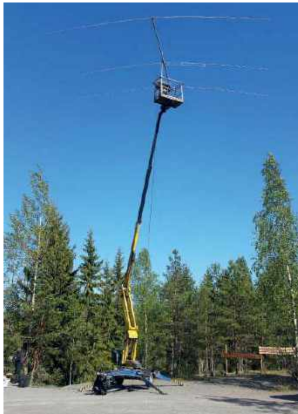
Nivelpuominosturin koriin kiinnitetty 14MHz:n 3el yagi -antenni Valkmusan kansallispuistossa vuonna 2017.
