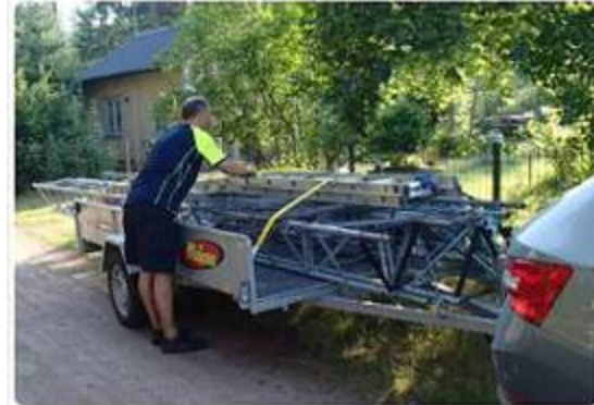
Ihan tavallisella 3,3 m lavakärnyllä onnistuu 6 m mastoristikoiden kuljetus. Kun takaylitys on sallittu 2 m, tulee kuorma 0,7 yli lavan etureunan. Näin tuotiin meidän masto. Harusvaljeriniput lastattiin kärnyn etuosaan, millä saatiin aisapaino sopivaksi.
