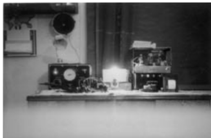
OH3RD:n ensimmäinen asema. Tx:n viritys, siksi signaaligeneraattori
