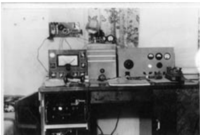
OH3RD:n asema vuodelta 1952. Vastaanotin Torotorin kelasarjasta, lähettimessä Clapp-VFO-buffe-rit ja 807. Antenninvirityslaitte seinällä
