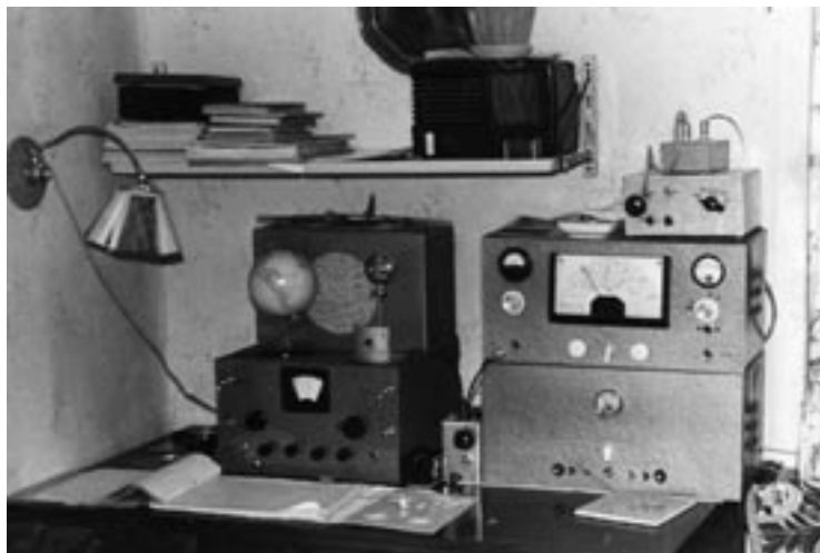
OH3RD:n asema 1957. Gelson VFO:lle rakennettu lähetin. Vastaanotin RP:n ensimmäinen prototyyppi.
